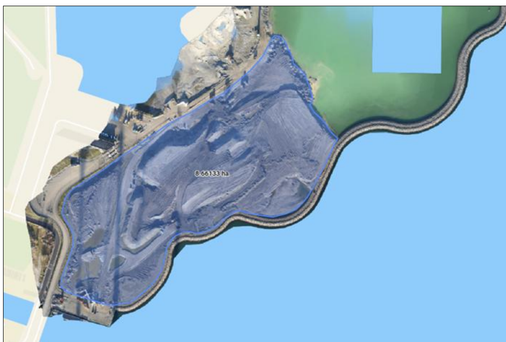
Billede 3: Dronefoto fra januar 2025 af Fase 1, bassin 1B – 8,7 ha opfyldt til over kote 0 DVR.
