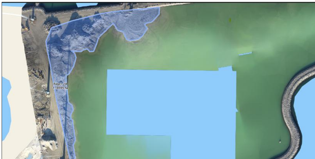
Billede 2: Dronefoto fra januar 2025 af Fase 1, bassin 1A – 1,2 ha opfyldt til over kote 0 m DVR.
