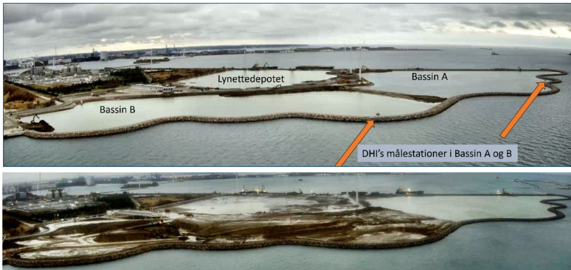
Figur 2-1 Luftfoto af Lynetteholm, Fase 1 med de to bassiner A og B med markering af, hvor DHI's stationer er placeret. Øverst juli 2023 og nederst december 2024. Bemærk at Bassin B ikke længere har et frit vandspejl, samt at der er sket jordopfyld i Bassin A.
