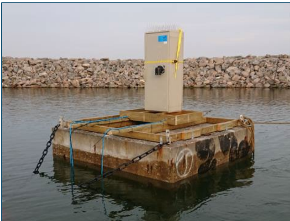
Figur C-2 Målestation for nitrat og salinitet, opankret i Bassin B. Nitratsensoren er horisontalt monteret via de to blå liner.
