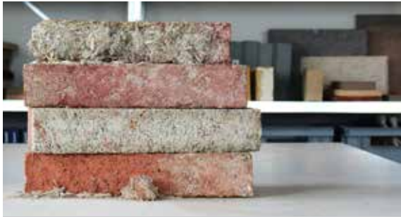
Hamp Hempcrete, bestående af hamp, kalk og vand, er et let og åndbart biogent materiale, der absorberer CO 2 og kan reintegreres i naturen.
