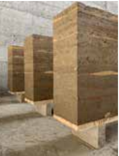
Jord Stampet lerjord kan bruges som bærende element i lette konstruktioner, det er potentielt lokalt tilgængeligt i Nordør og det vil også kunne genanvendes i et cirkulært perspektiv.
