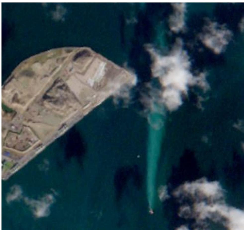
Figur 5-4 8. februar 2024: Gravearbejderne ved Lynetteholm skaber en synlig sedimentfane mod nord.
