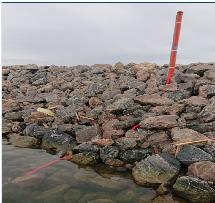
Figur 2-1 Vandstandsmåler sat fast i stendæmningen med tryksensor ude i bassinet
