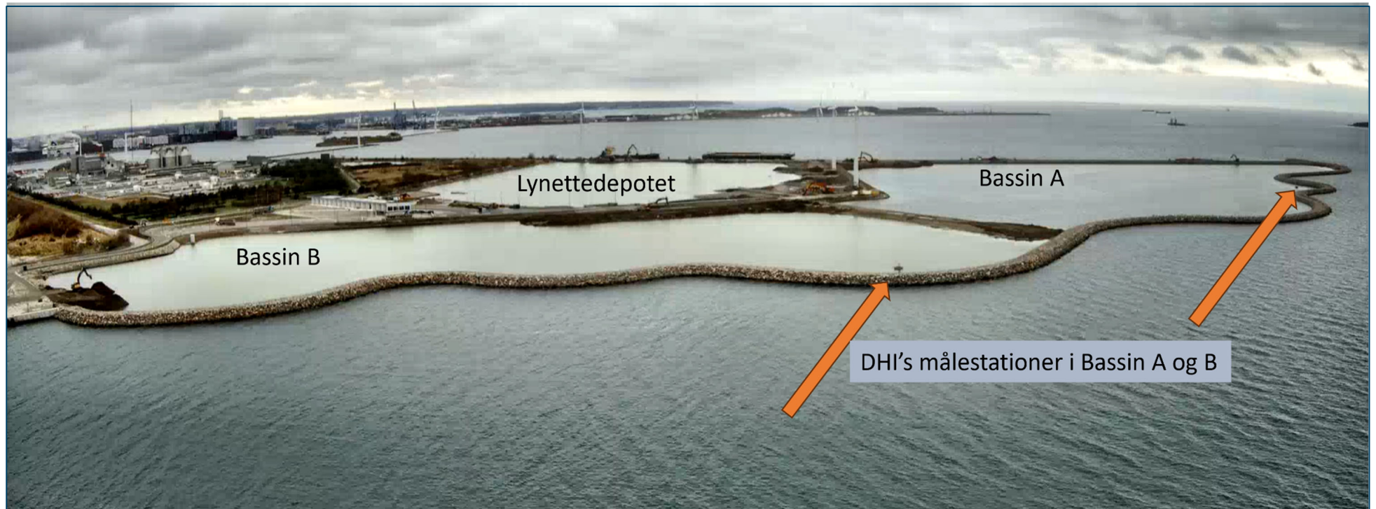
Figur 2-3 Luftfoto af Lynetteholm, Fase 1 med de to bassiner A og B, samt markering af, hvor DHIs stationer er placeret.
