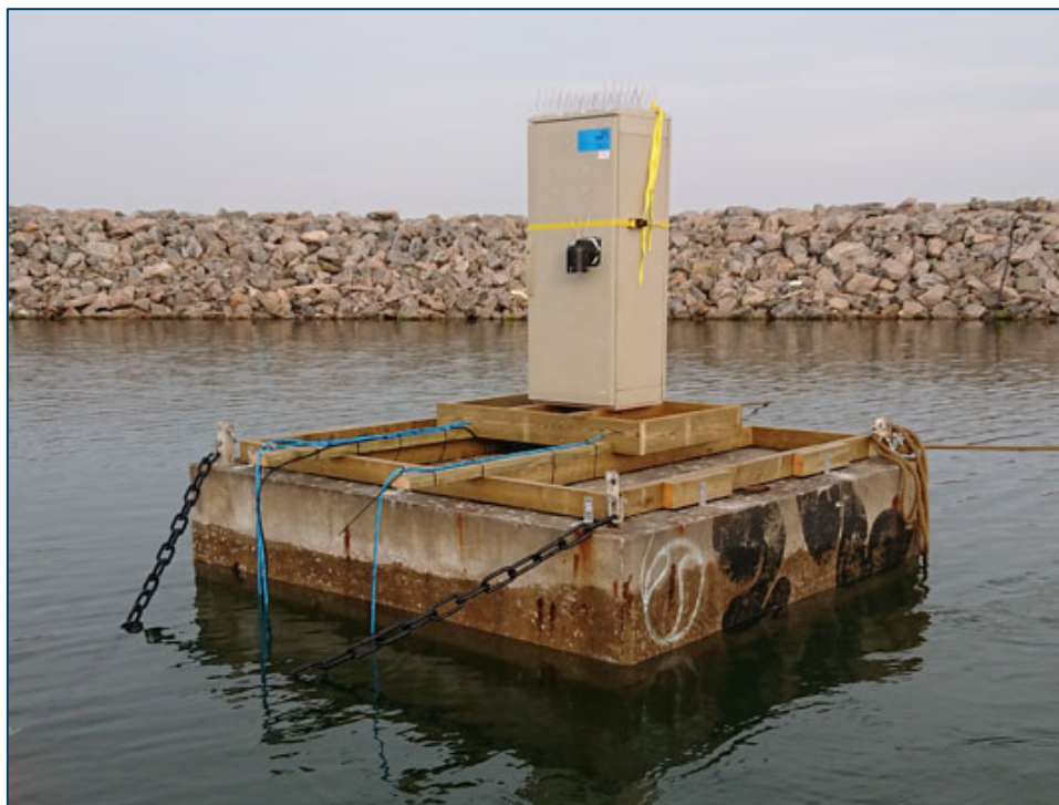
Figur 2-2 Målestation for nitrat og salinitet, opankret i Bassin B. Nitratsensoren er horisontalt monteret via de to blå liner.
