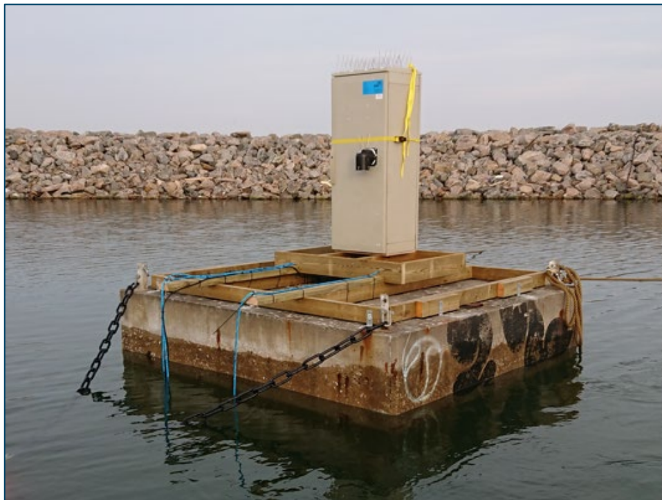
Figur 2-2 Målestation for nitrat og salinitet, opankret i Bassin B. Nitratsensoren er horisontalt monteret via de to blå liner.
