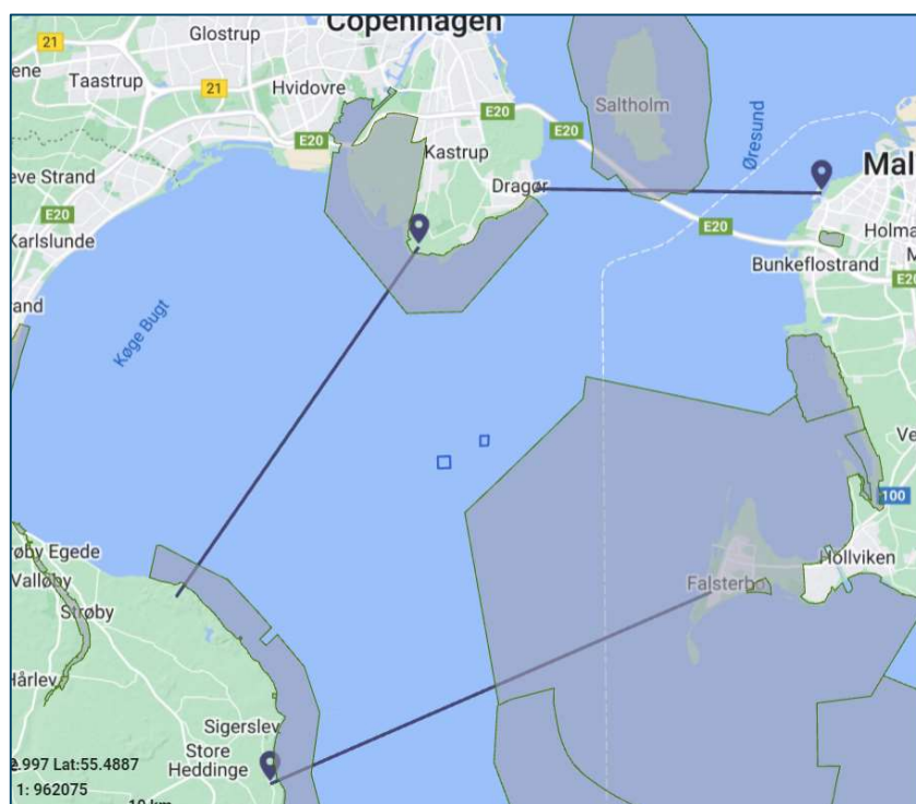
Figur 18 Placering af de tre tværsnit (Østersøen, Nordlige Øresund og Køge Bugt), hvorover sedimentfluxen beregnes.
