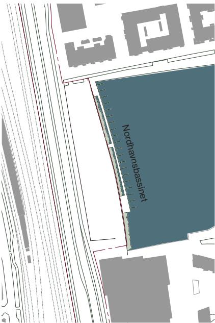
Stensætning langs kaj kanten.
