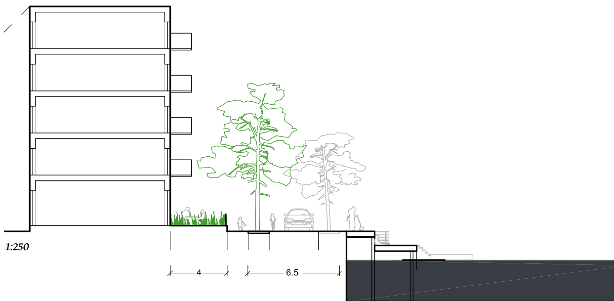
Snit i Sandkaj hvor bryggen er 5 m. Her er mulighed for ophold, passage og beplantning i for eksempel plantekasser.
